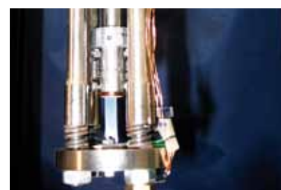
Kryostat mit eingespanntem Siliziumkristall
