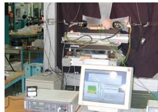
Versuchseinrichtung zur Bestimmung der Werkstoffparameter im zweiachsigen Zugversuch
