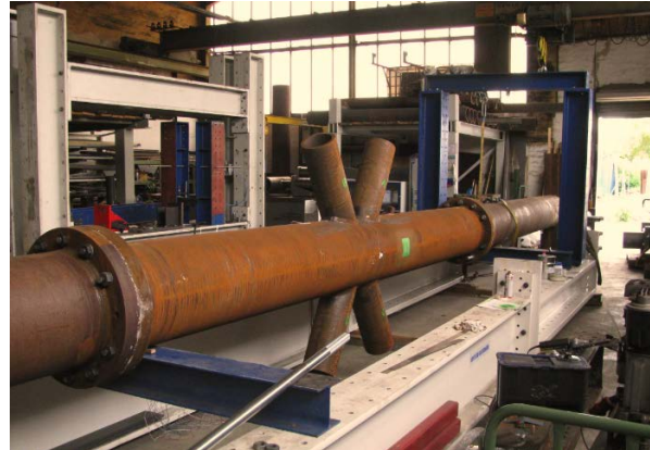
Großbauteilversuch eines geschweißten K-Knotens unter zyklischer Belastung
